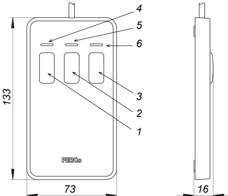
Рисунок 8. Общий вид и габаритные размеры ПДУ
