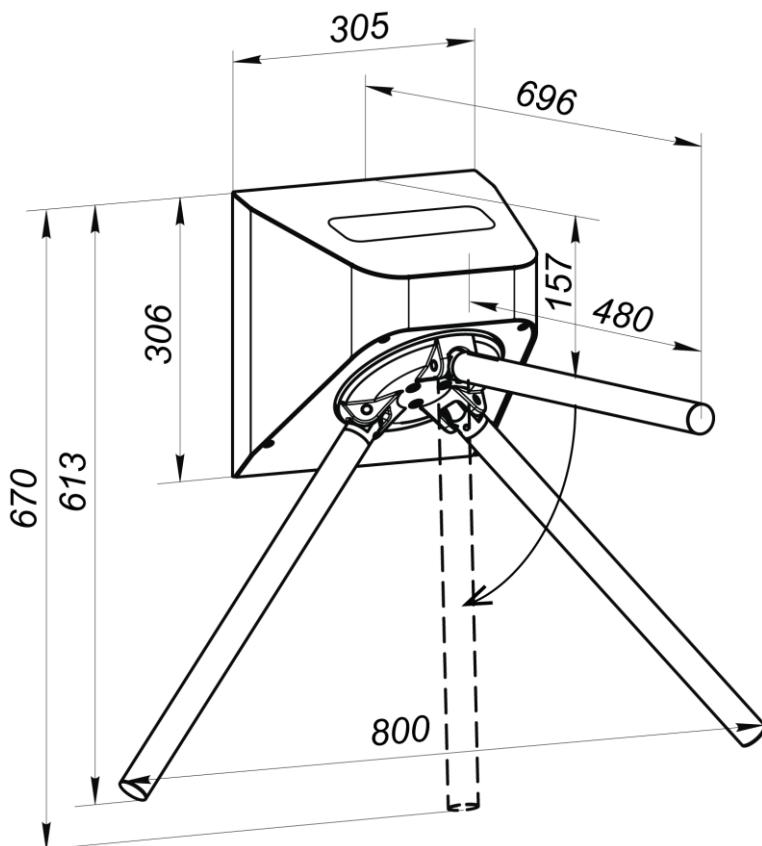
Рисунок 1. Габаритные размеры турникета без монтажного кронштейна (стойки)
