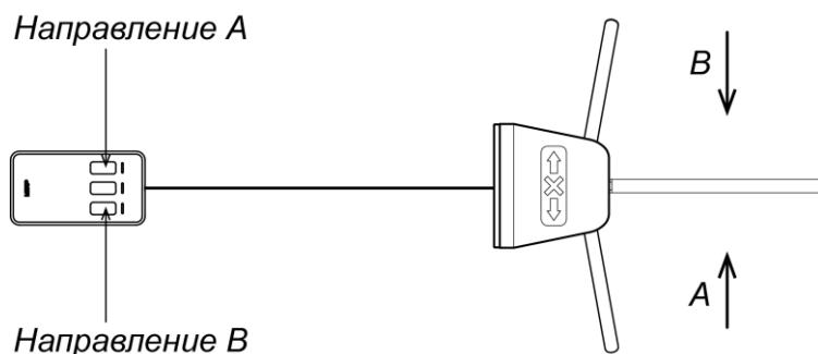
Рисунок 13. Стандартная ориентация ПДУ относительно стойки турникета
