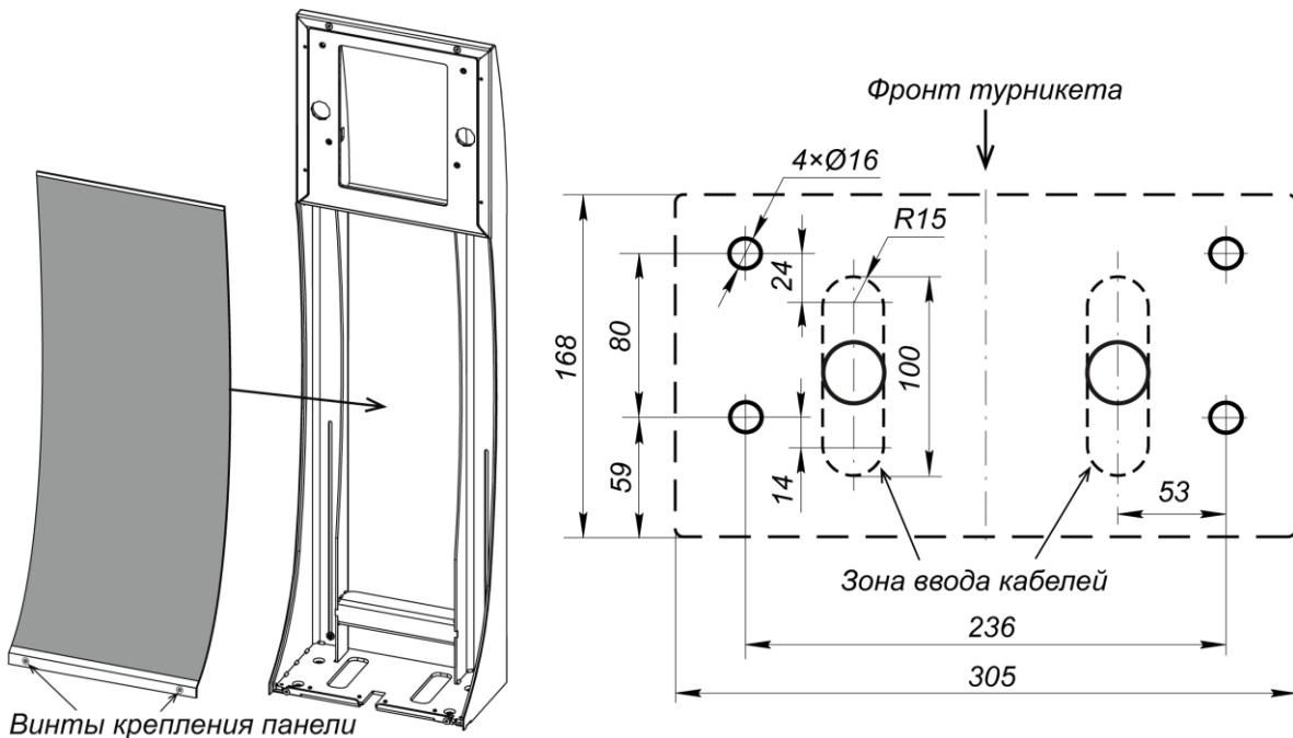
Рисунок 19. Порядок монтажа и схема разметки отверстий для стойки PERCo-MT10.3<sup>1</sup>
