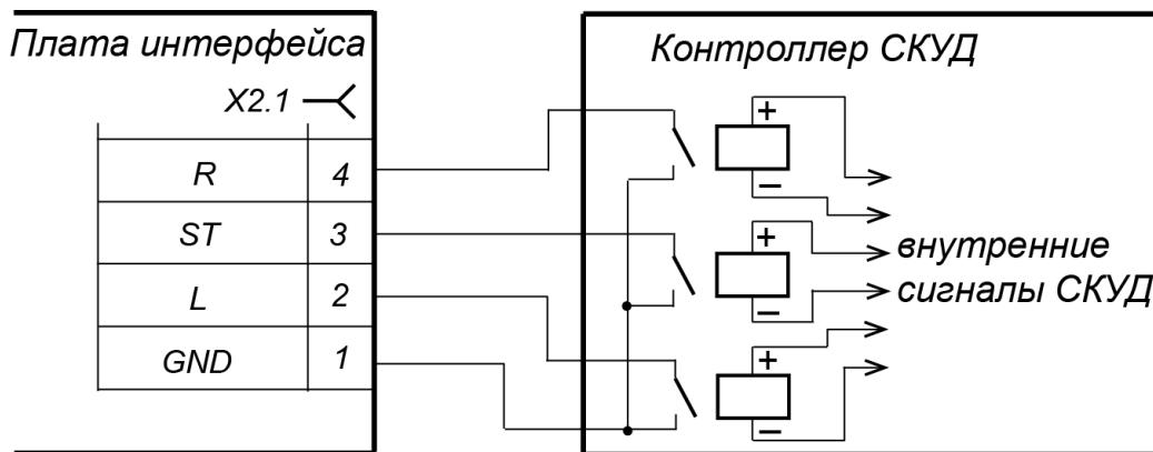
Рисунок 11. Управляющий элемент СКУД – нормально разомкнутый контакт реле
