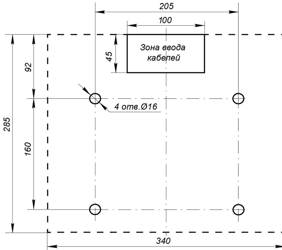
**Рисунок 12. Разметка отверстий в полу под крепление стойки турникета (пунктиром показаны габариты основания)<sup>1</sup>**
