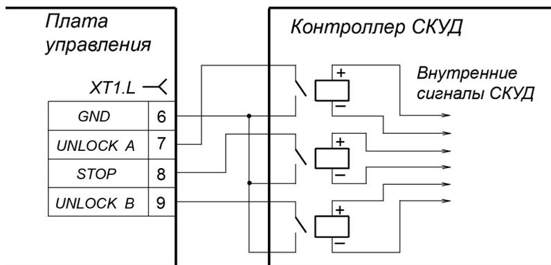
Рисунок 5. Управляющий элемент СКУД – нормально разомкнутый контакт реле
