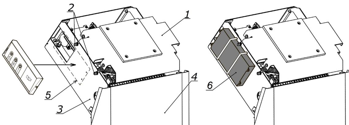
**Рисунок 13. Вид турникета без крышки, места установки считывателей**
