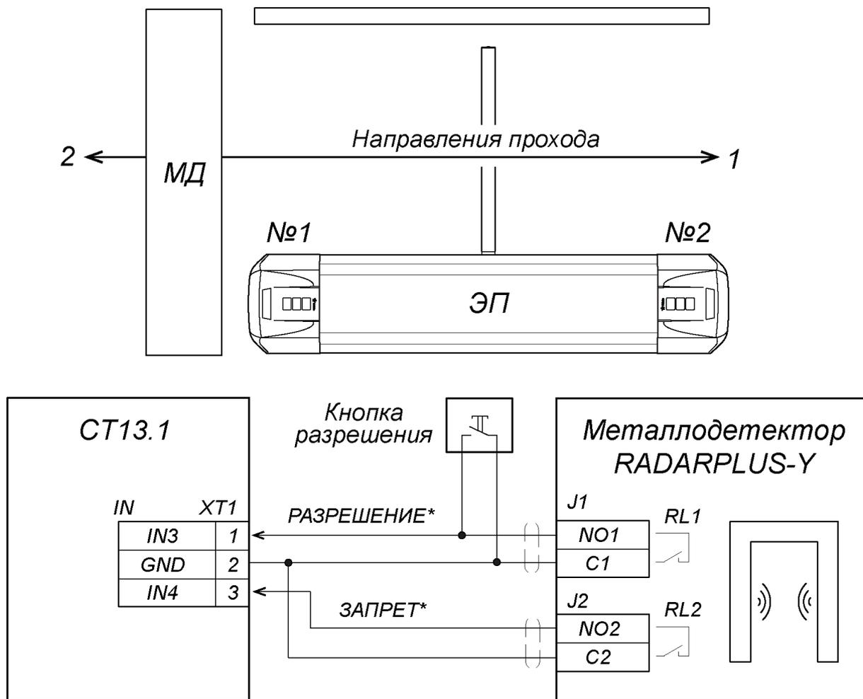
\* - для подключения выходов металлодетектора РАЗРЕШЕНИЕ и ЗАПРЕТ используются два разных входа контроллера из любых свободных.
