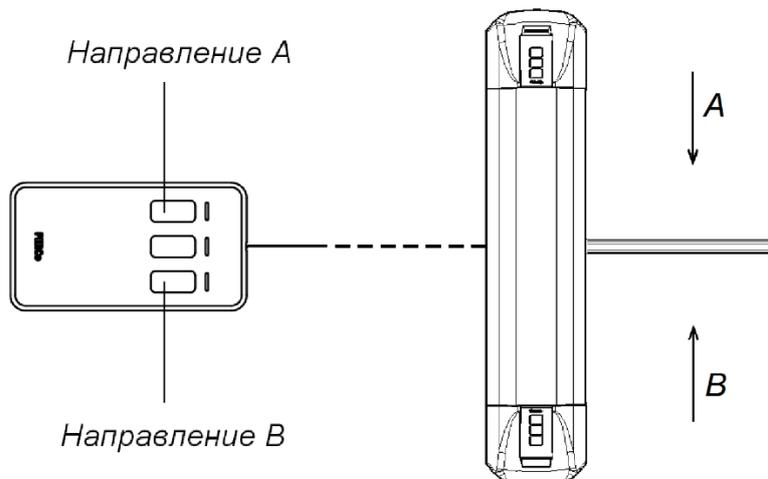
**Рисунок 8. Стандартная ориентация ПДУ относительно стойки ЭП**
