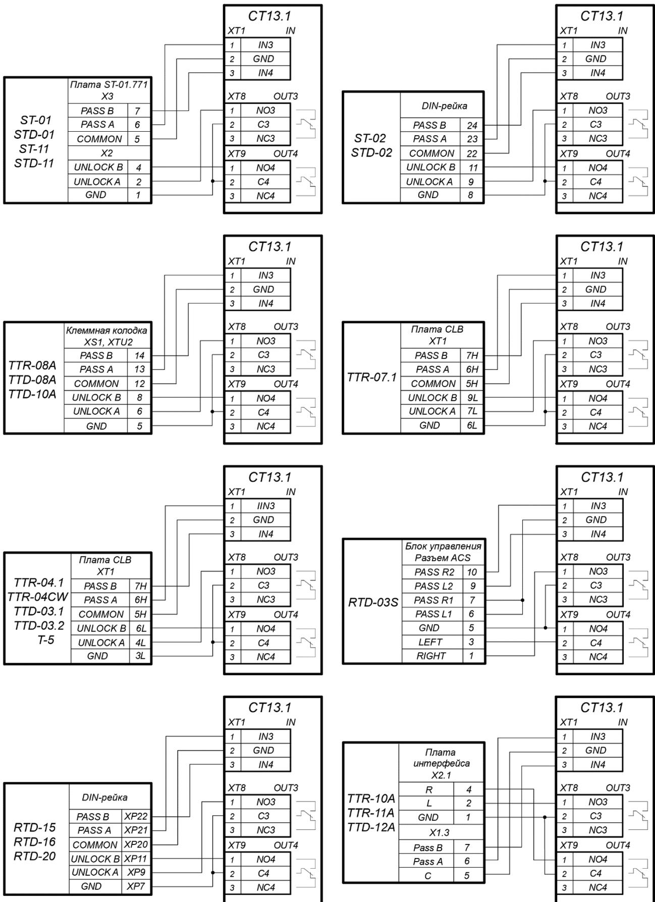
Рисунок 18. Схемы подключений турникетов в варианте конфигурации «Управление турникетом»
