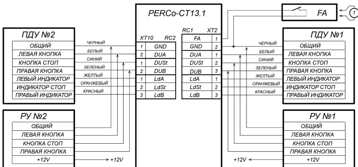
① – провод-перемычка, устанавливается при отсутствии устройства FA
