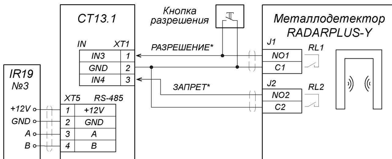
\* - для подключения выходов металлодетектора РАЗРЕШЕНИЕ и ЗАПРЕТ используются два разных входа контроллера из любых свободных.
