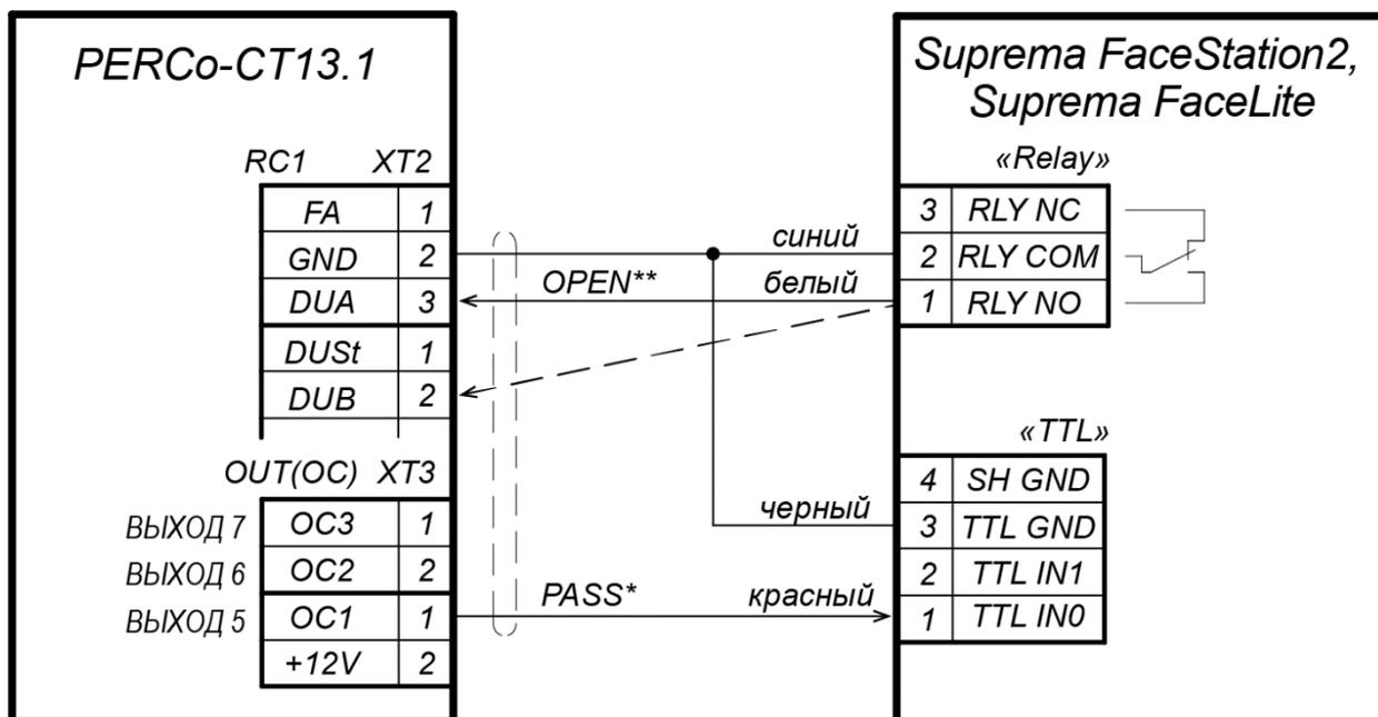
\* - для сигнала PASS может быть использован любой свободный выход контроллера ЭП (тип выхода - «Обычный»), для него в Web-интерфейсе необходимо задать внутреннюю реакцию:
