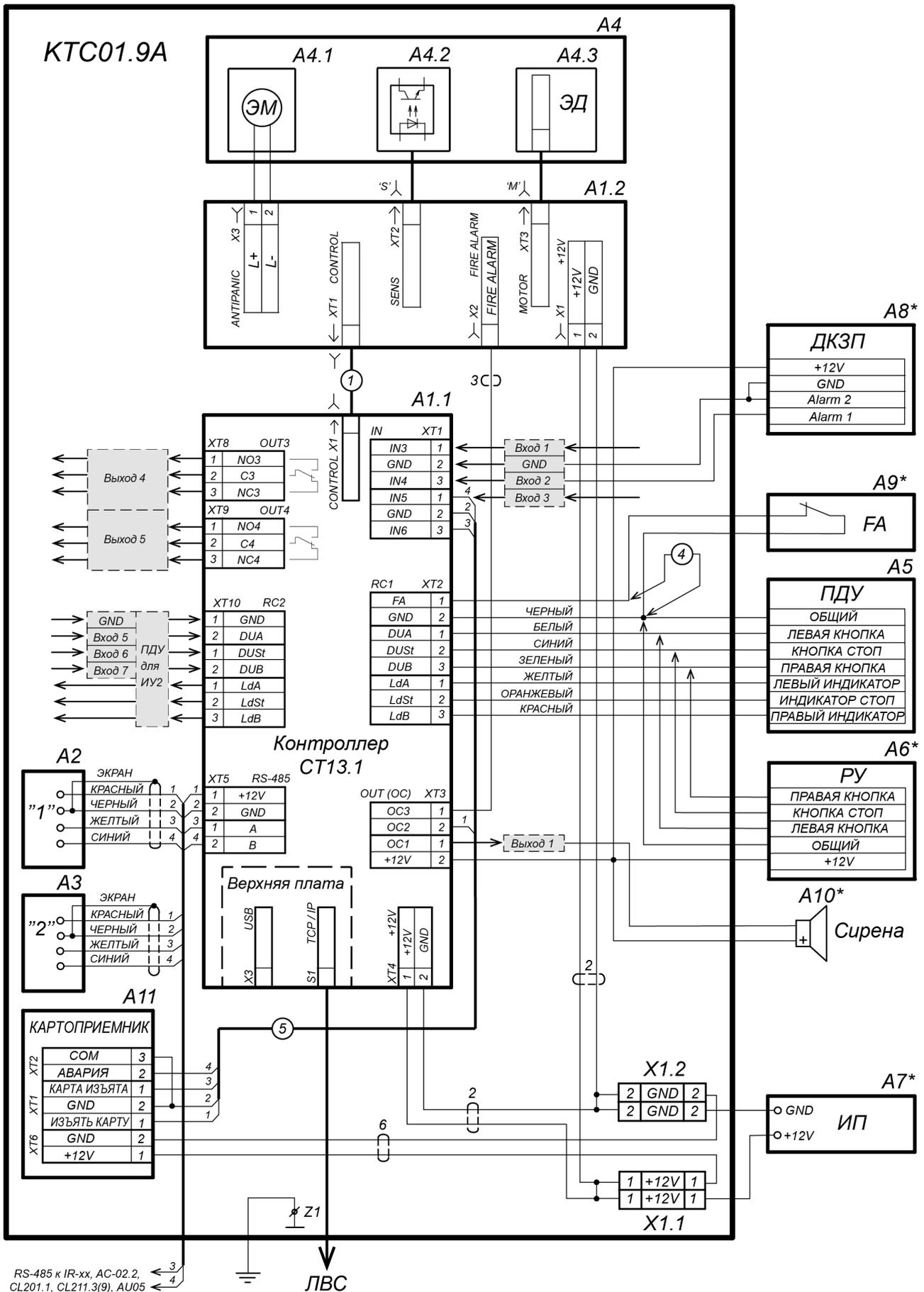
Рисунок 14. Схема подключения ЭП и дополнительного оборудования
