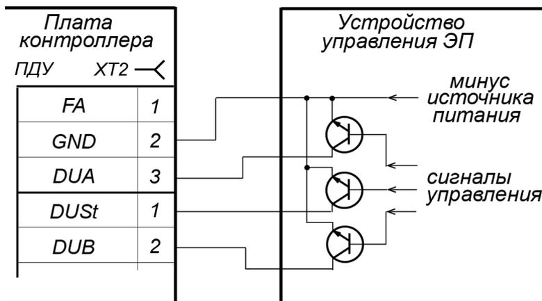
Рисунок 10. Управление ЭП схемой с открытым коллекторным выходом
