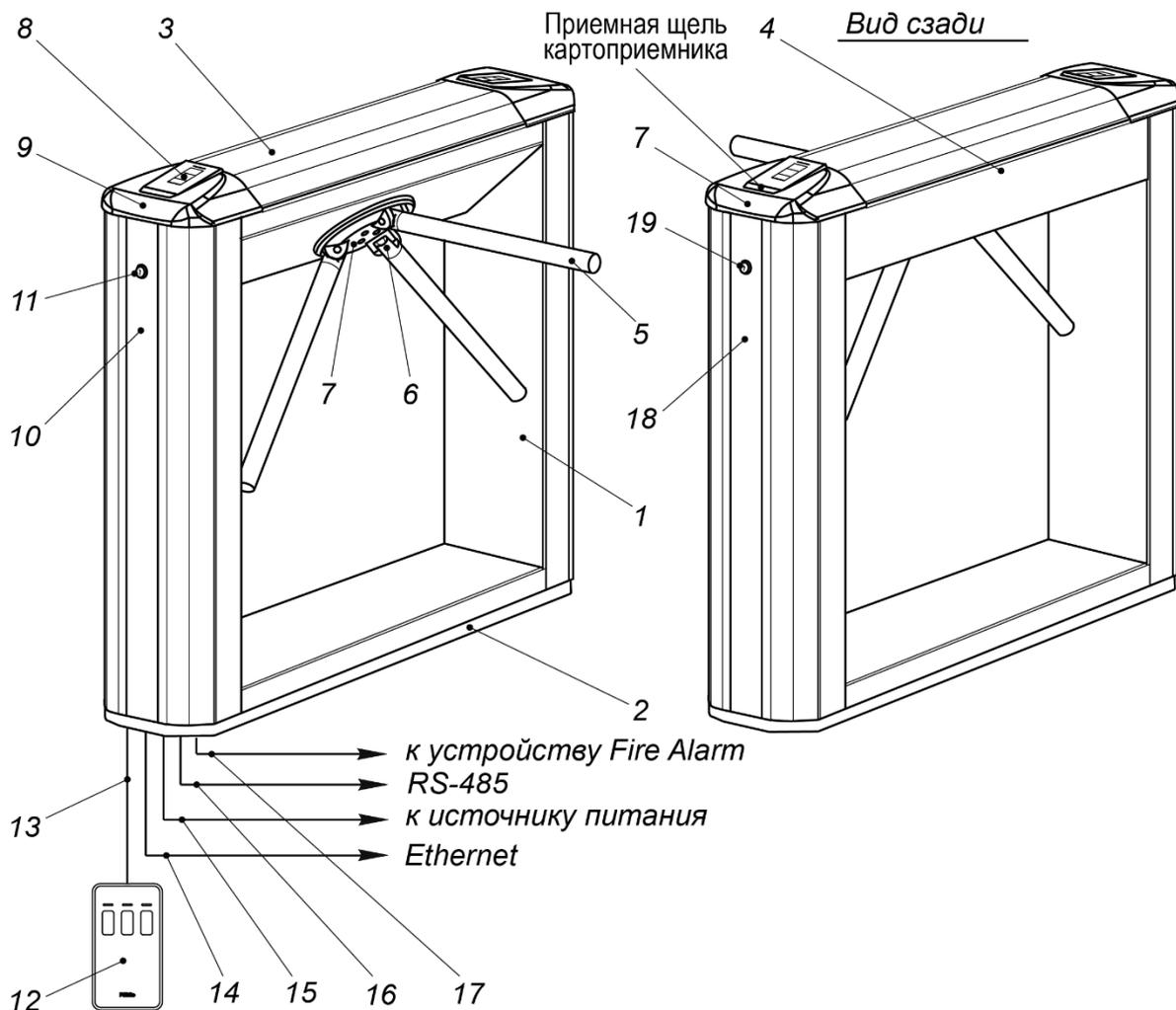
**Рисунок 2. Устройство ЭП**
