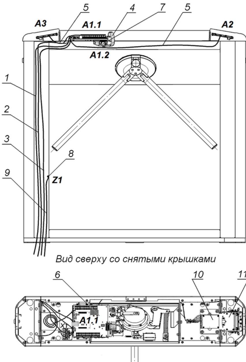
**Рисунок 13. Схема прокладки кабелей в стойке ЭП**
