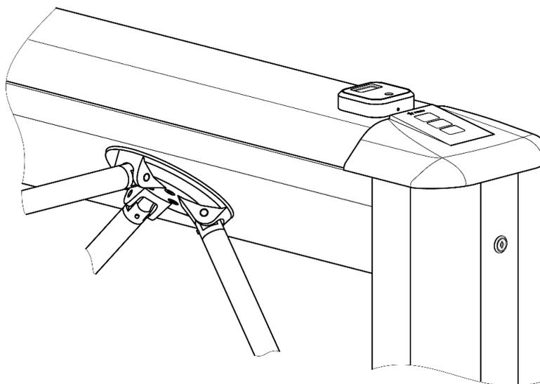
**Рисунок 33. Место установки пирометра PERCo-AT01 на крышку ЭП**
