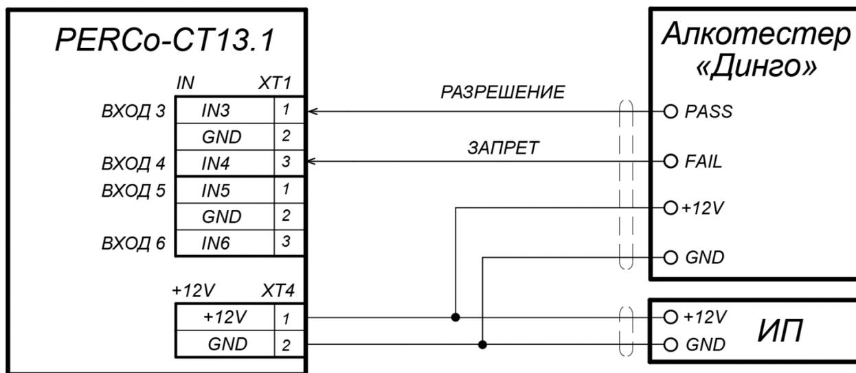
Рисунок 29. Схема подключения алкотестера «Динго В-02» (ООО СИМС-2)
