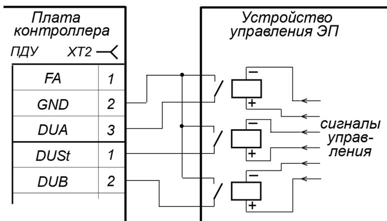
Рисунок 9. Управление ЭП нормально разомкнутым контактом реле
